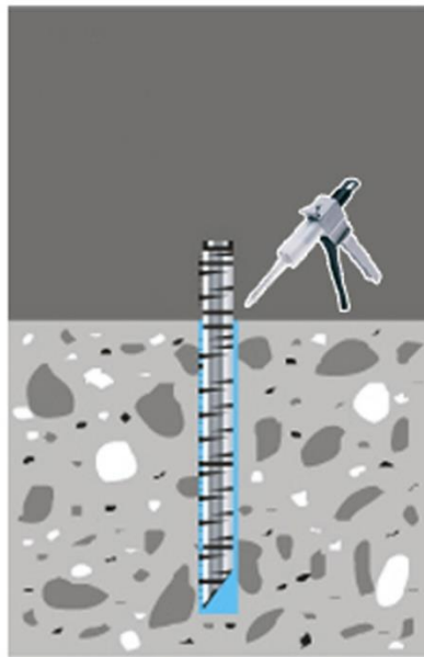
4. 灌入 AB 膠(植筋膠)進行防水處理
